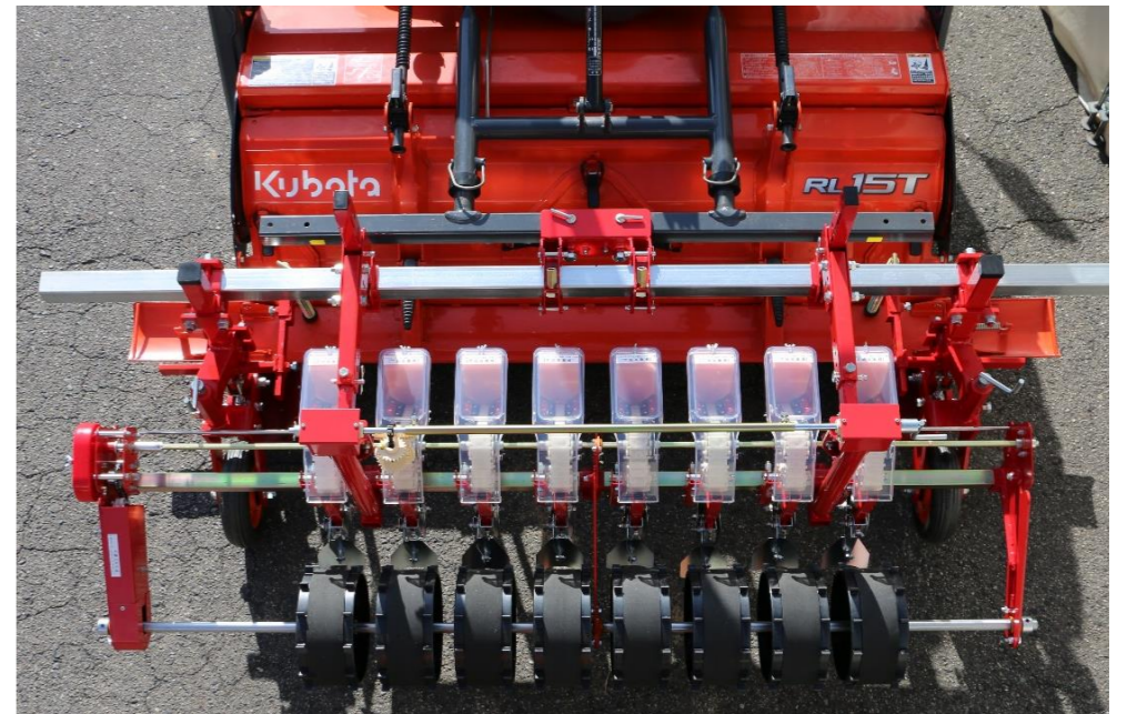
うね成型部 うね上面幅はロータリ幅-35cmになります。
