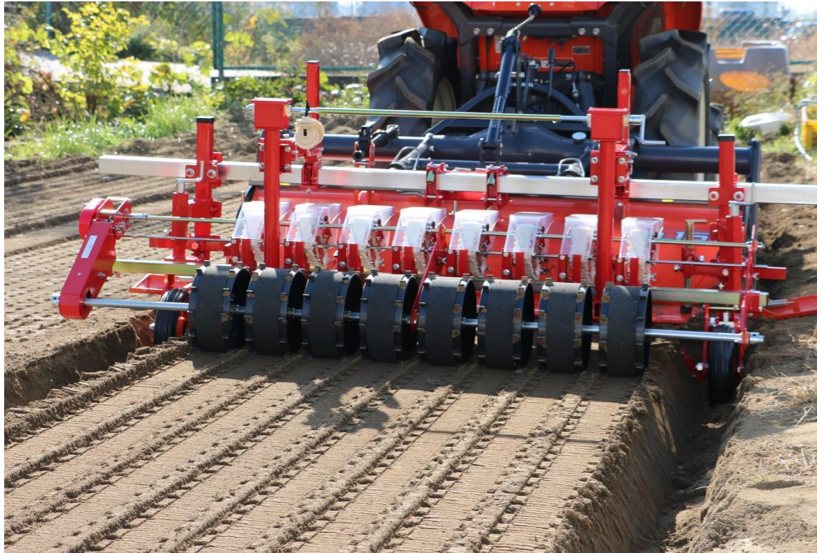
上写真はうね高さ15cmのリッジャーU15タイプの作業時
