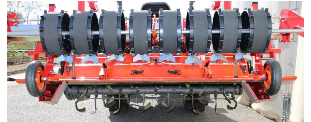
うね成型部 うね上面幅はロータリ幅-35cmになります。
